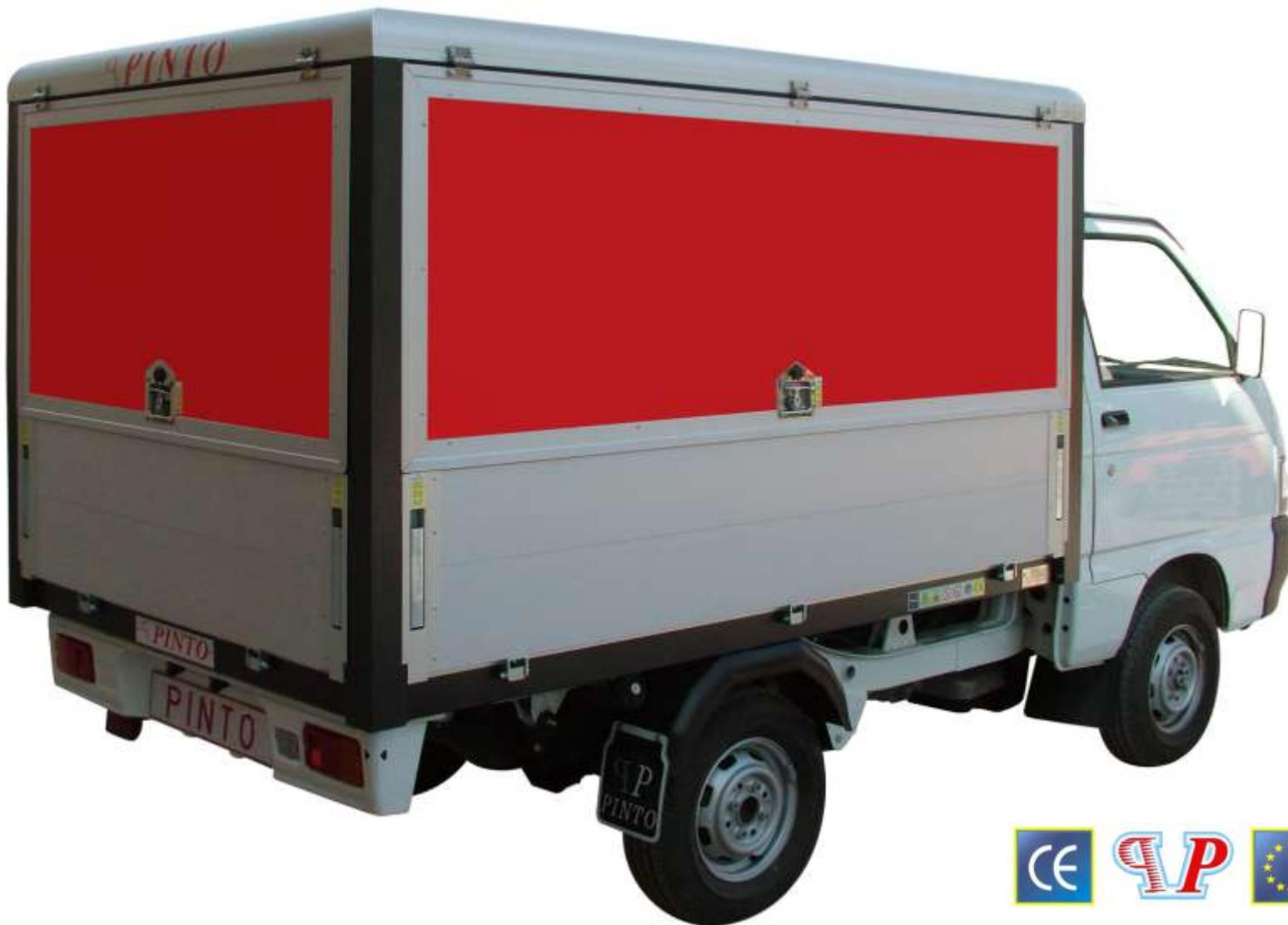
**Pannelli sandwich coibentati con K termico 1 W/m<sup>2</sup> K. Colore Opzionale.**
